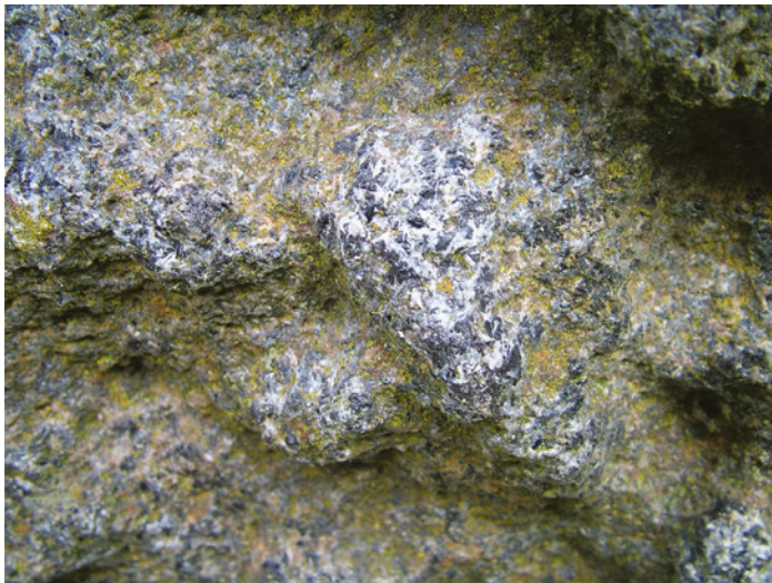
5.4 pav. Gabras-diabazas. Matyti būdinga struktūra, kurią sudaro pailgi balti padrikai išsidėstę plagioklazo kristalai
